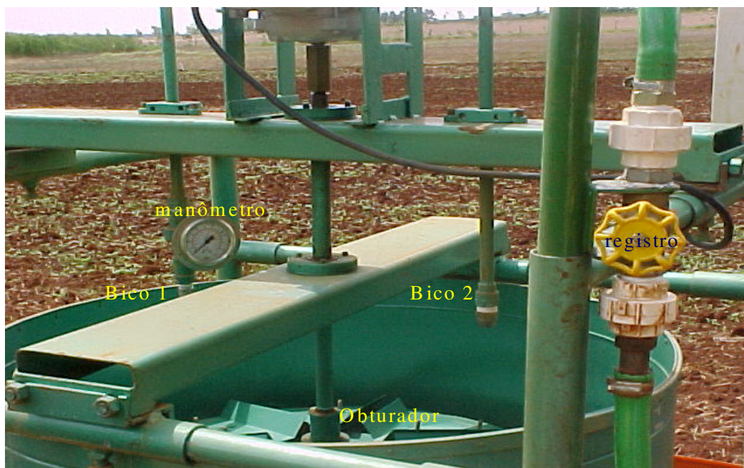
Figura 2. Sistema regulador da intensidade de precipitação (obturador rotativo, manômetro, bicos e registro).
